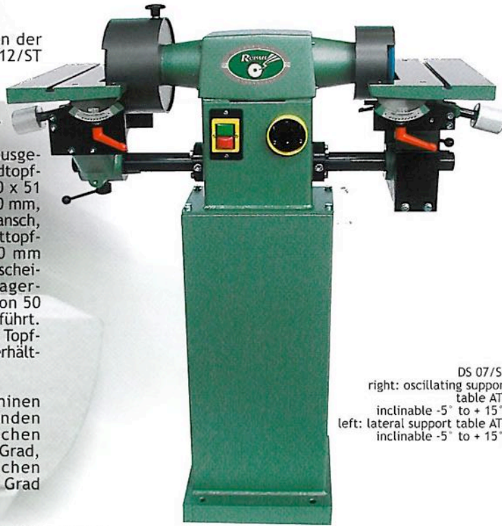
DS 07/ST rechts: seitlicher Auflagetisch ATS (Federschwingtisch) neigbar -5° bis +15°, links: seitlicher Auflagetisch ATF (feststehend) neigbar -5° bis +15°
