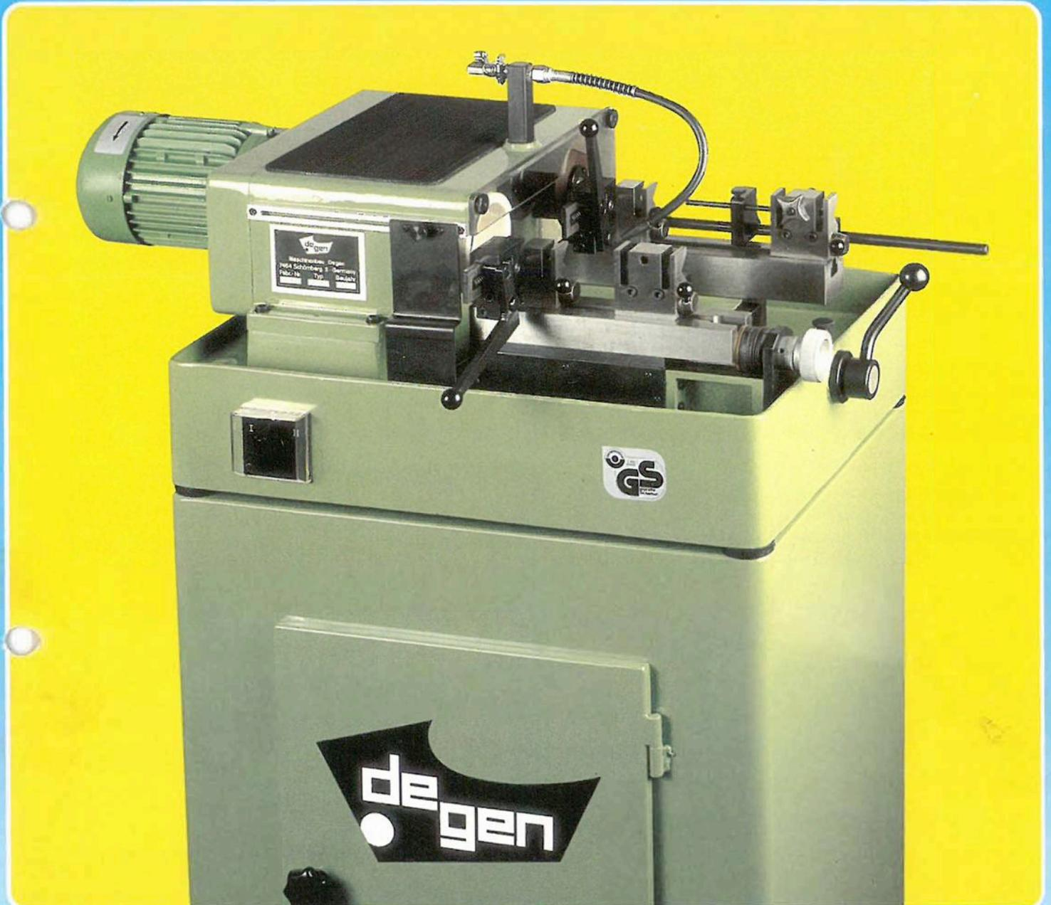
**Für sekundenschnelles Trennen und Planschleifen von Auswerferstiften, Auswerferhülsen, Lochstempeln usw.**
