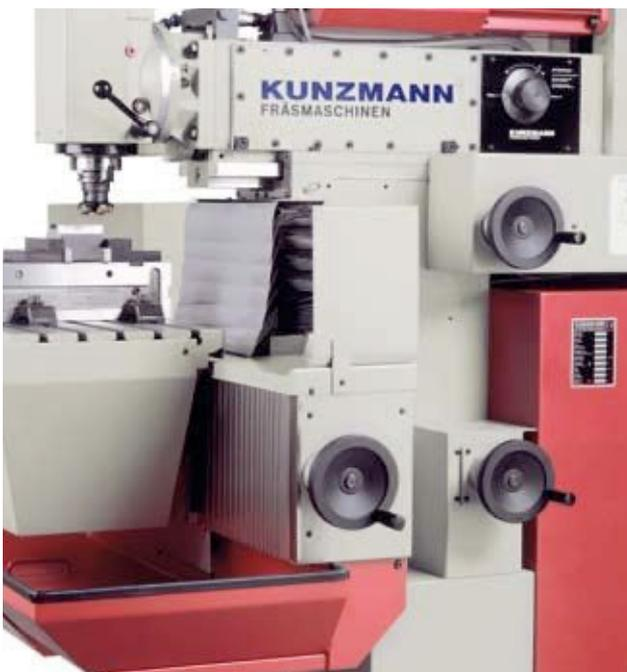
Ergonomisch angeordnete Sicherheitshandräder zum manuellen Verfahren
